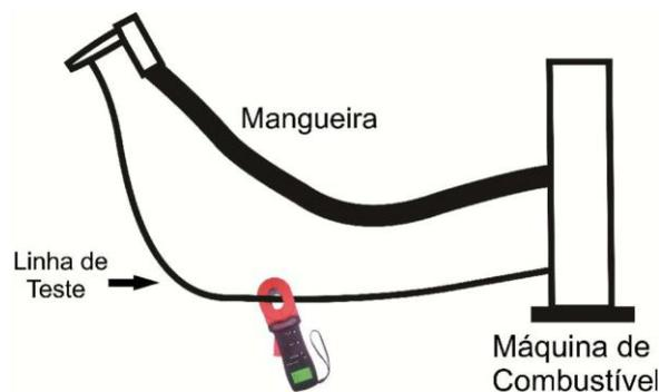
Conecte a pistola de reabastecimento e a máquina de combustível com um cabo de teste a faça a medição do valor **RT** com o instrumento. Você irá obter:
