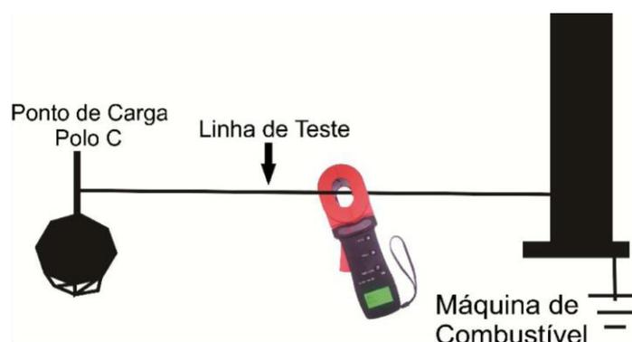
Como mostrado no gráfico acima, encontre o pólo terrestre que está além do pólo terrestre da máquina de combustível, assim como o pólo terrestre do ponto de carga; depois, conecte os dois pontos com um cabo de teste e faça a medição do valor **RT** com instrumento.
