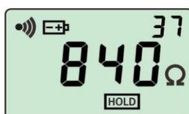
7. Função alarme ativado, o valor medido excedeu o valor crítico da configuração do alarme. Lendo medição armazenada no grupo 8. A resistência medida é de 820Ω.
